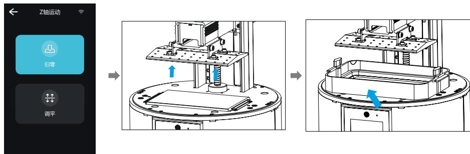
3. 按触摸屏“归零”, 控制Z轴上移, 至合适位置, 放入料盘, 对准料盘两端螺孔后, 旋紧两端的料盘固定螺丝。
