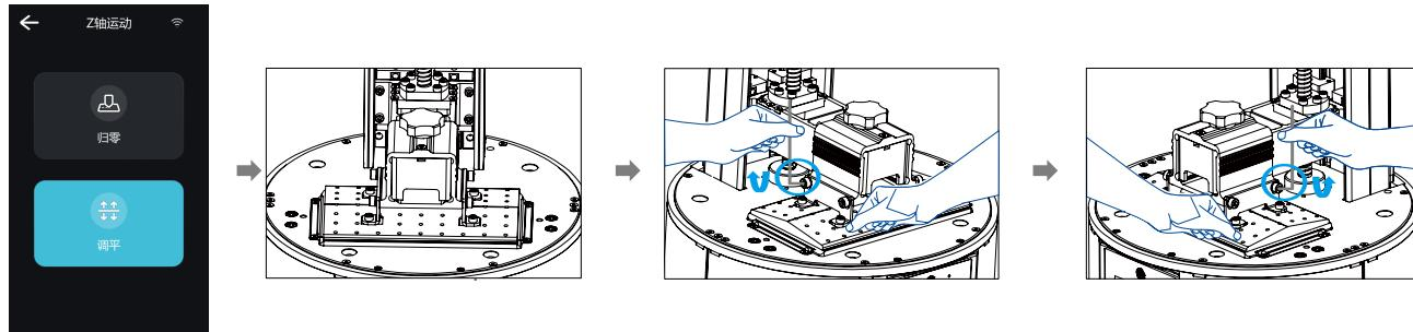
1. 拧松调平螺丝后, 按触摸屏“调平”, 将打印平台贴合在打印屏上。
